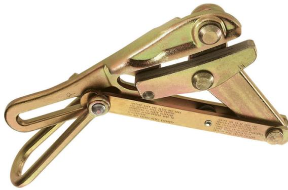
Diseñado para ser utilizado en cables revestidos resistentes a la intemperie, cables de aluminio y de cobre, conductores revestidos con PVC, cables portadores y cables de acero trenzado. El tensor tipo Chicago fue diseñado para cables de 0,12" a 1,0" (3,10 a 25,4 mm). Al tensar cable de acero galvanizado de alta resistencia, la galvanización tiende a cubrir las mordazas del tensor y provoca el deslizamiento del cable. El contorno en doble "V" reduce este riesgo y daños al cable.
