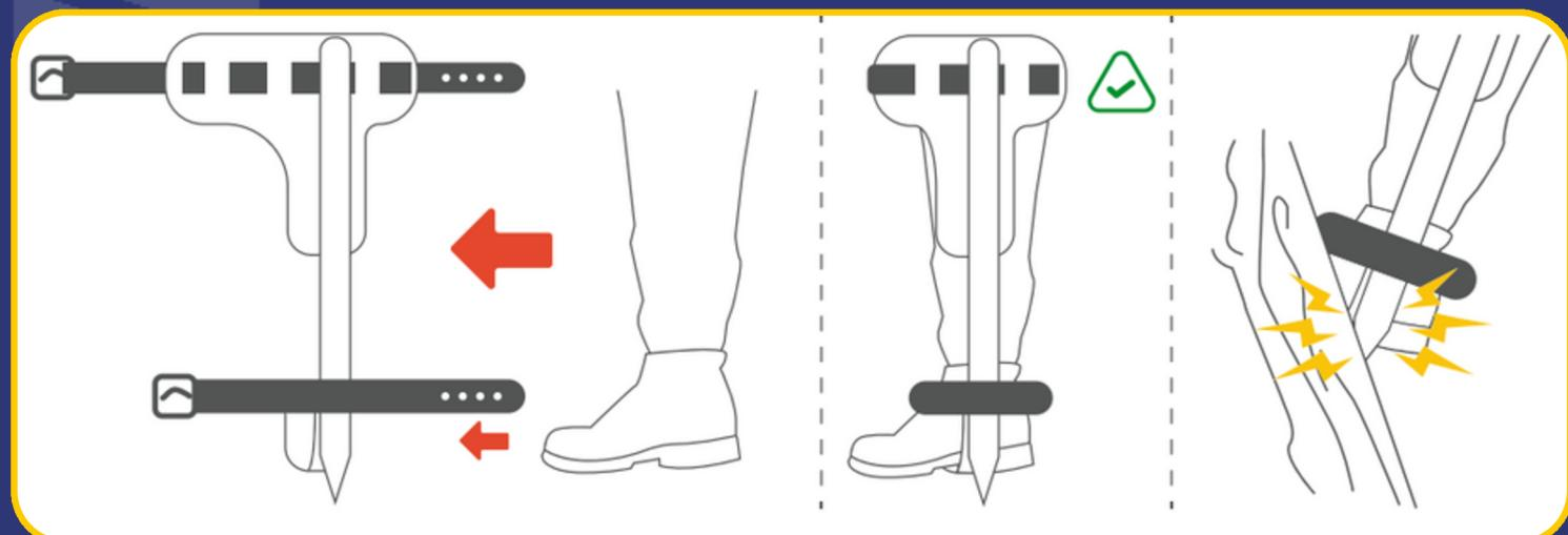
1. Oriente las puntas de acero hacia la parte interna del forjado hacia la parte interna del pie para un correcto uso.
